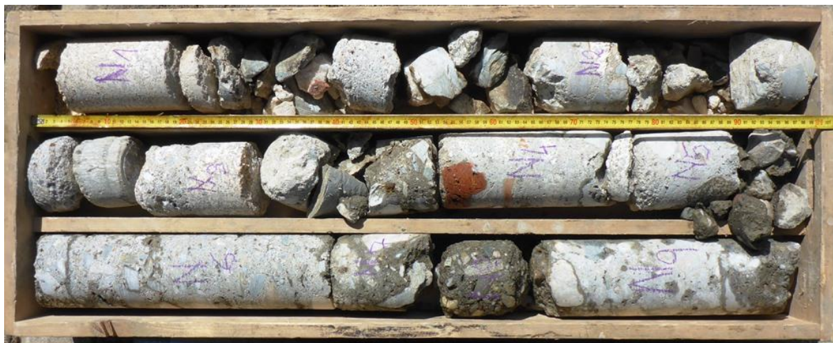
N – odebraný vzorek jádra z návodní části jezového pilíře.
