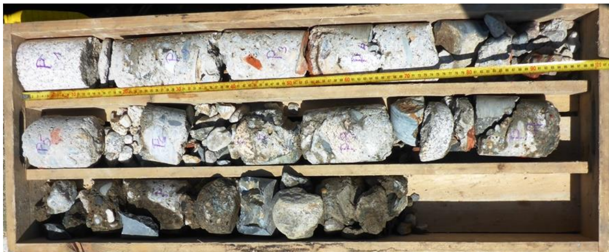
P – odebraný vzorek jádra z povodního konce jezového pilíře.
